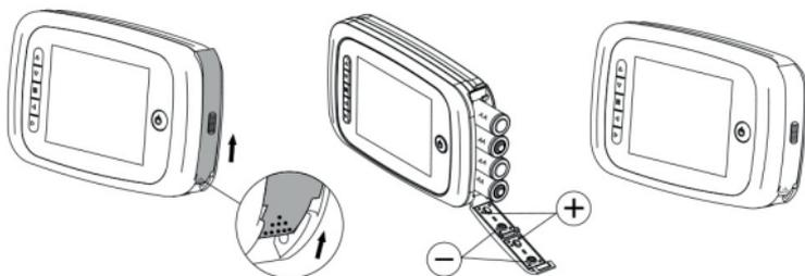
1. Den Verschlussdeckel nach oben schieben und wie im Bild nach aussen drehen.
